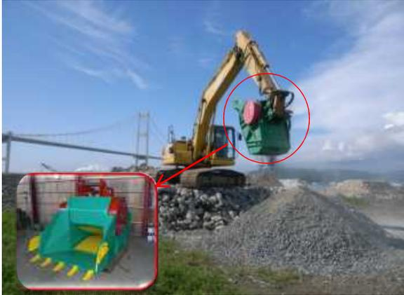
再生骨材製造機/バケットクラッシャー(FU-70)
