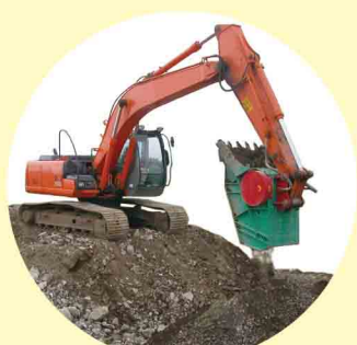
バックホウ(山積0.8m 3 )に装着・骨材製造状況
