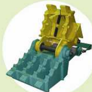
再生栗石製造機 (GG-200) ※写真はバックホウ(0.8m 3 )装着タイプ
