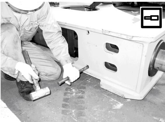
プレスピンとハンマーを使って、各セットアップダンパを押し出す
