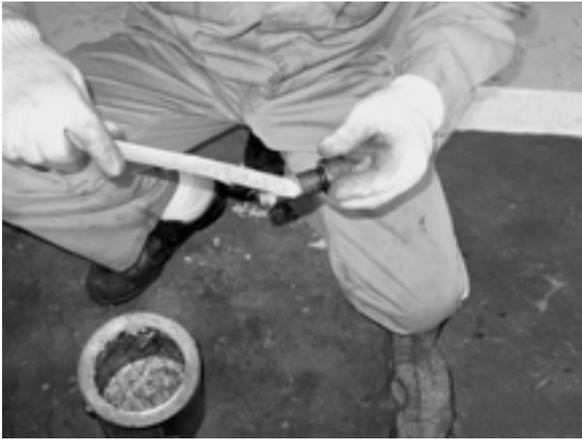
アキュムレータ固定用の各ソケットボルトのネジ部にネバーシーズを塗布する
