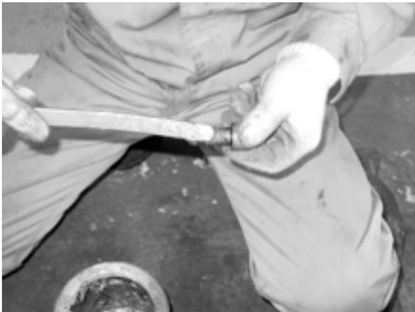
アキュムレータカバー固定用の各ソケットボルトのネジ部にネバーシーズを塗布する
