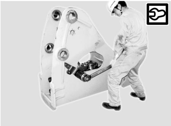
パワーレンチを使って各ボルトを締付ける
