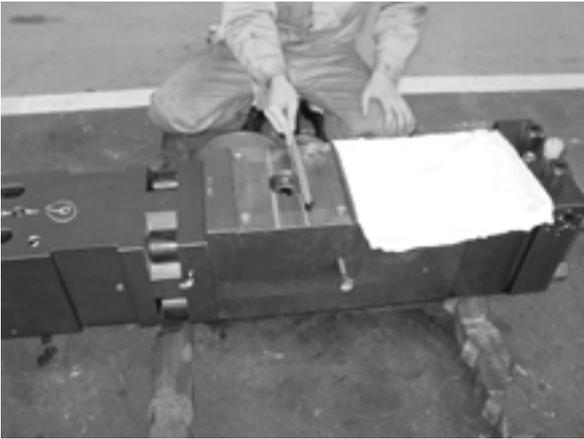
シリンダのアキュムレータ取付け部に作動油を塗布する
