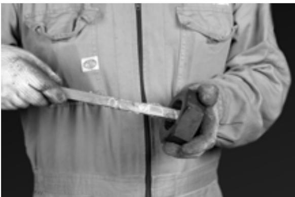
ネバーシーズを各ナットのネジ部に塗布する
