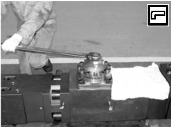
アキュムレータカバー固定用の各ソケットボルトを締付ける
