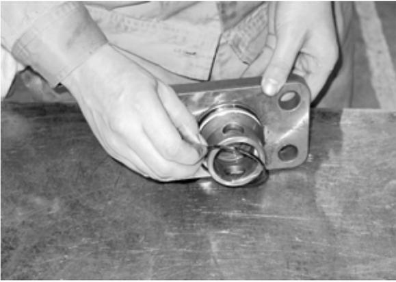
オーリング(2個)とバックアップリング(1個)をバルブハウジングカバーから外す
