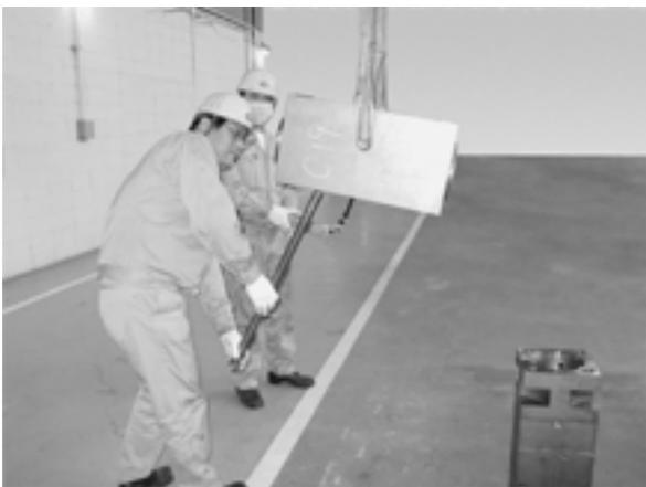
ボルトにパイプを装着する。つぎにパイプとクレーンを使ってゆっくりシリンダの向きを変える
