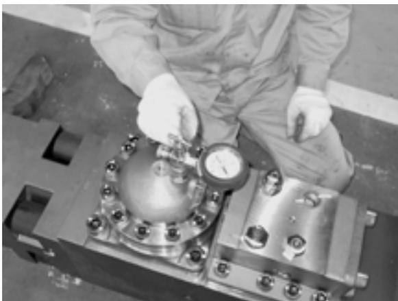
逃し弁を開き、ガスを完全に抜く
