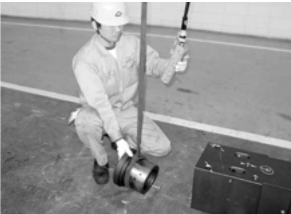
フロントカバーにスリングを装着し、吊り上げる
