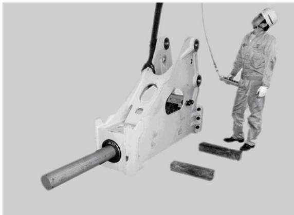
クレーンとスリングを使って、ブレーカを吊り上げておこす
