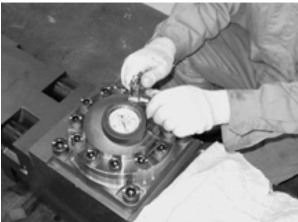
圧力計を見ながら、ガスが規定圧に達するまで三方弁の逃がし弁を開く
