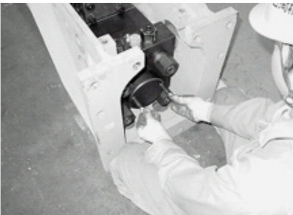
各 M16 ボルトをバックヘッドに装着する
