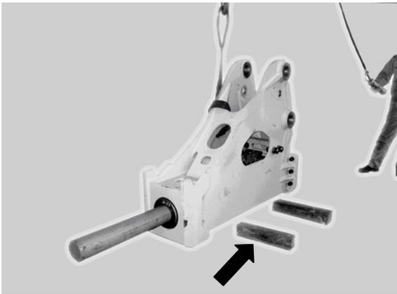
スリングをブレーカに装着して、吊り上げる
