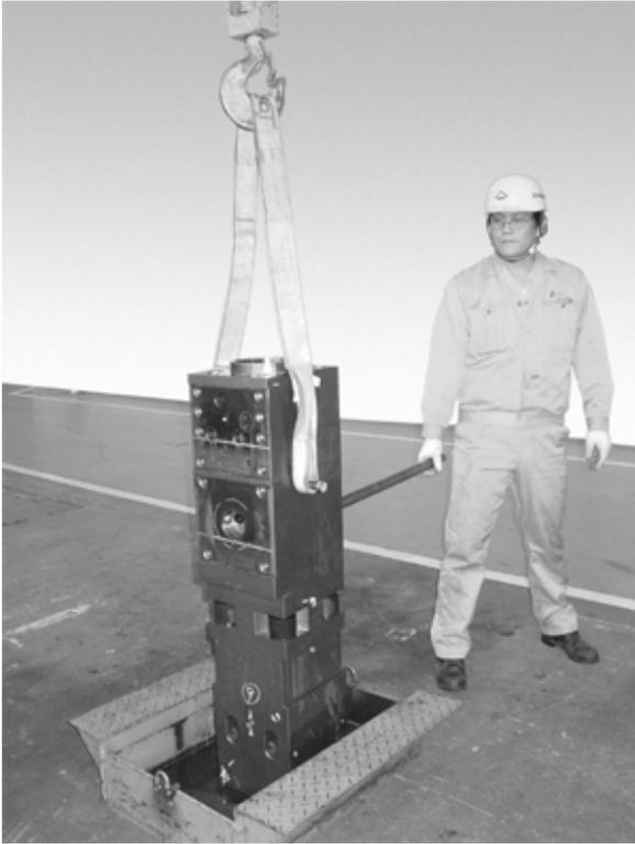
スリングおよびパイプを各ボルトに装着して、シリンダを保持する
