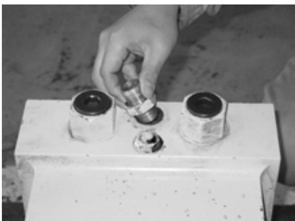
エア給気コネクタをバックヘッドに装着する
