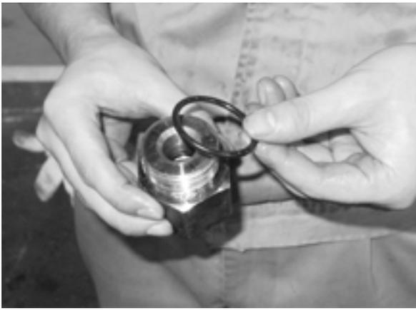
各オーリングを油圧給排ポート(IN/OUT)コネクタに装着する
