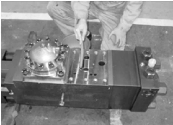
シリンダのバルブハウジング取付け部に作動油を塗布する
