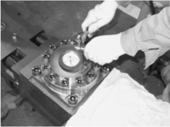
窒素ポンペのバルブを閉じ、三方弁の逃がし弁を開き、ホース内のガスを完全に抜く
