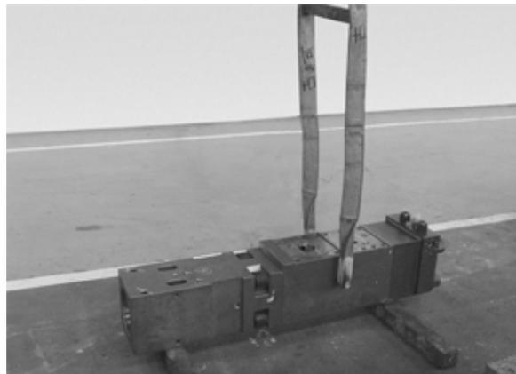
各ボルトにスリングを装着してブレーカを吊上げる
