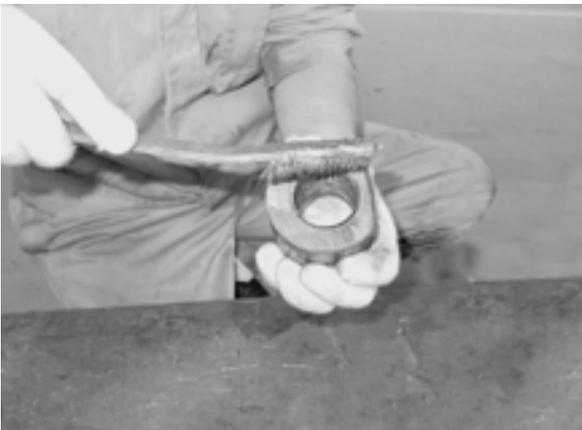
各ナットの上面にネバーシーズを塗布する
