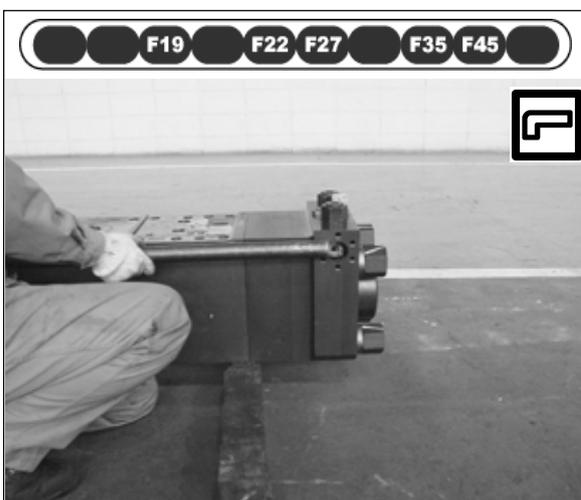
油圧給排ポート(IN/OUT)の各GPFプラグを緩める
