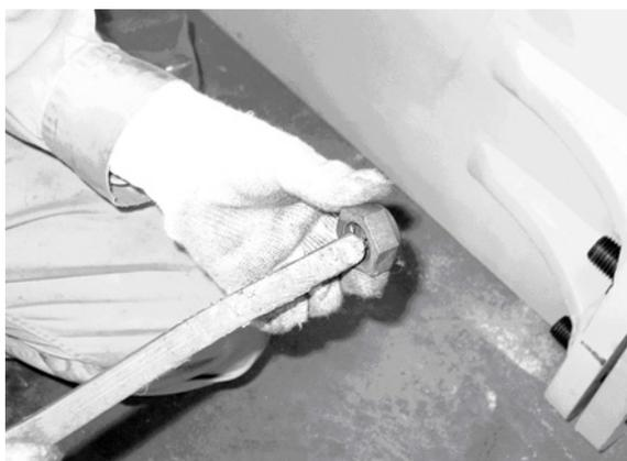
各第1ナットのネジ部にネバーシーズを塗布する
