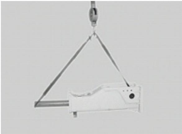
再びブレーカを吊上げてT-ボックスに挿入する
