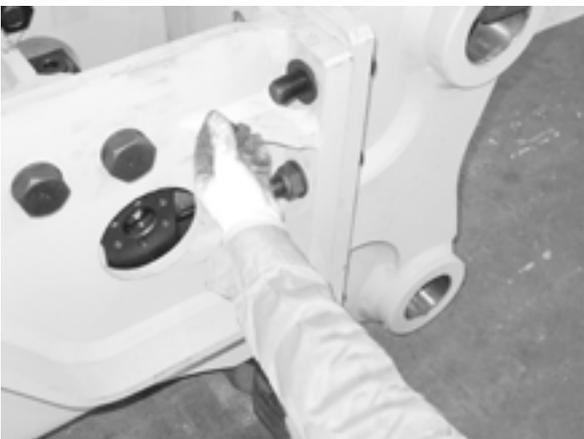
仮装着した各第1ナットを以下のように正しく装着する
