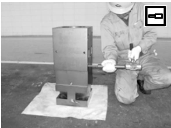
プレスピンとハンマーを使って、ラバープラグを完全に装着する
