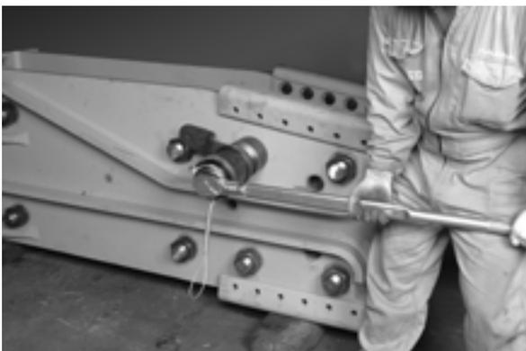
各第1ナットにパワーレンチを装着し、締付ける
