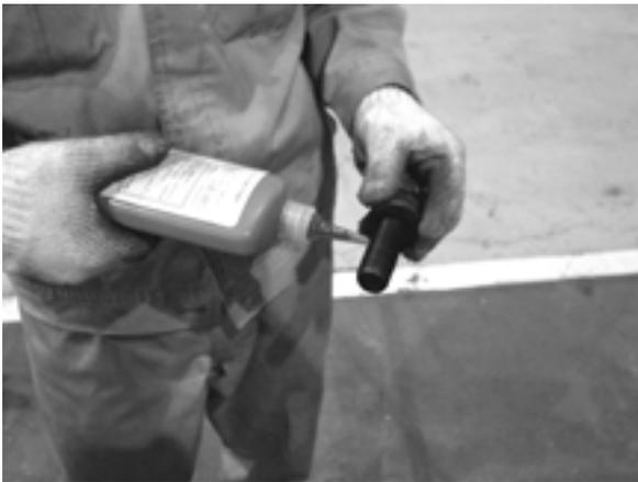
各ボルトのネジ部に中強度ネジロック\*を塗布する
