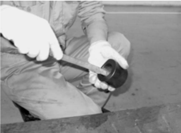
各ナットのネジ部にネバーシーズを塗布する
