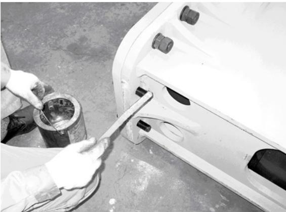
各ボルトのネジ部にネバーシーズを塗布する
