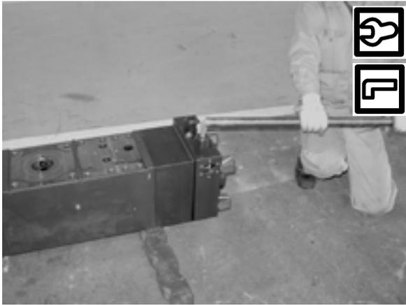
油圧給排ポート(IN/OUT)の各GPFプラグおよびコネクタを緩める
