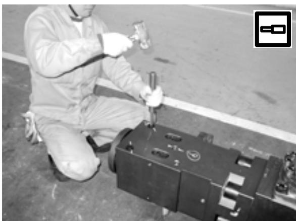
プレスピンとハンマーを使って、各ラバープラグを完全に装着する
