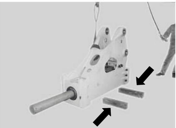
ブレーカにスリングを装着して吊り上げる
