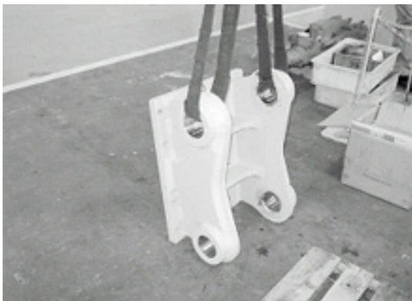
クレーンとスリングを使って、トップブラケットを吊り上げる
