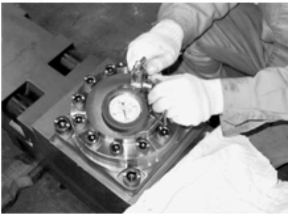
三方弁の逃がし弁を開き、ガスを完全に抜く
