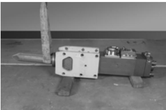
ロッドにスリングを装着して、吊り上げる
