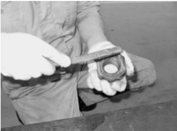
各ナットの端面にネバーシーズを塗布する
