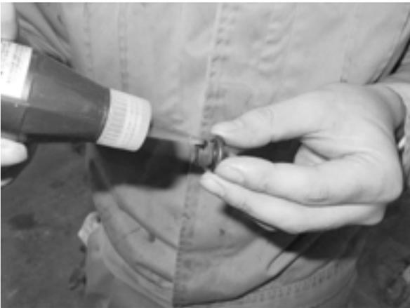
GPFプラグのネジ部に低強度ネジロックを塗布する
