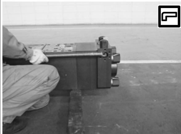
油圧給排ポート(IN/OUT)の各GPFプラグを緩める
