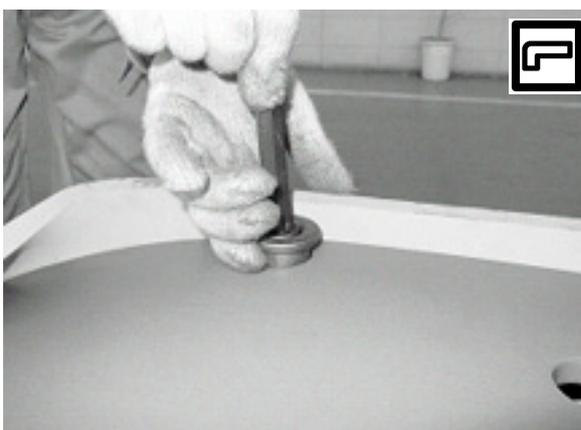
各ボルトをカラーに挿入し、装着する
