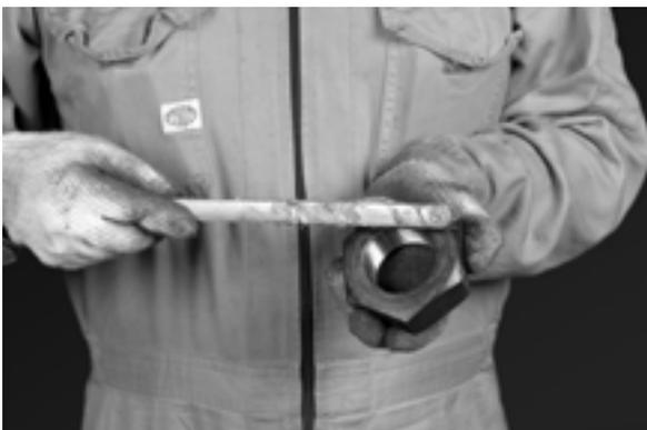
ネバーシーズを各ナットの端面に塗布する
