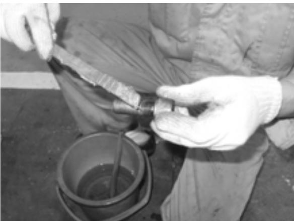
バルブハウジングカバーの各ソケットボルトのネジ部にネバーシーズを塗布する
