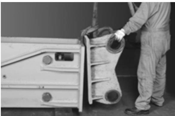
クレーンとスリングを使って、トップブラケットをサイドプレートに装着する
