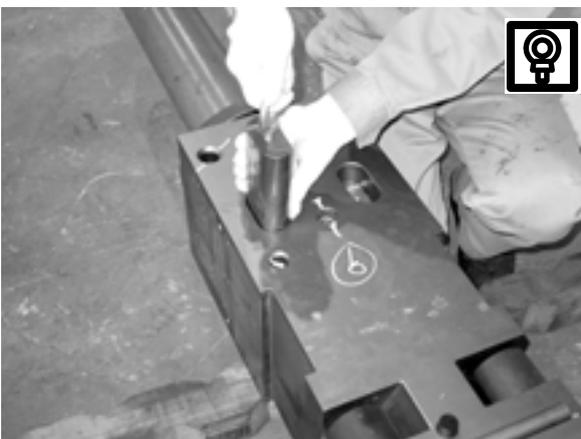
M12 アイボルトを持ち上げて、各ロッドピンをフロントヘッドから抜く
