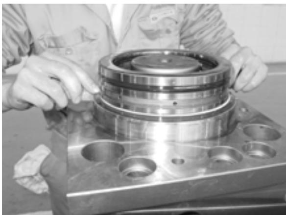
バックアップリングの飛び出している量を均一に調整する
