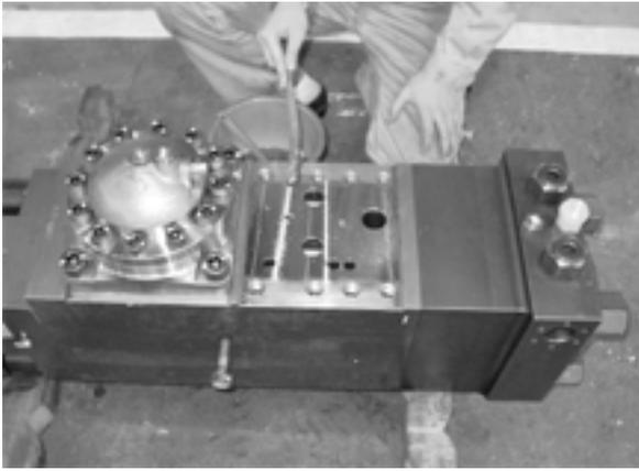
シリンダのバルブハウジング取付け部にネバーシーズを塗布する
