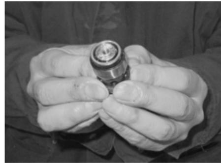
作動油をリサイジングスリーブの内面に塗布する。
