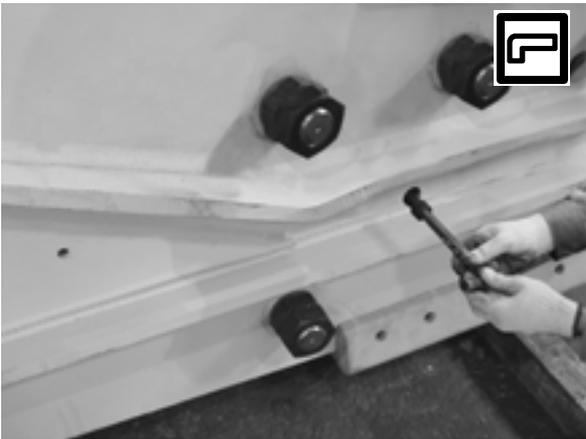
各socketボルトを装着し両側のサイドプレートを固定する
