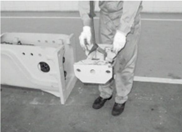
スペーサにスリングを装着して吊上げる
