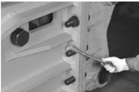
ネバーシーズを各ボルトのネジ部に塗布する
