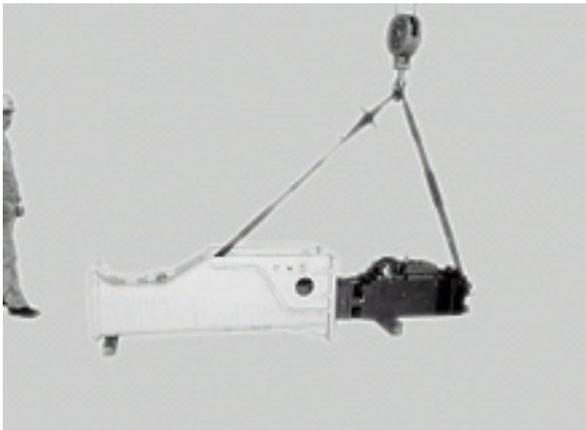
スリングの装着位置をロッド側に変更する
