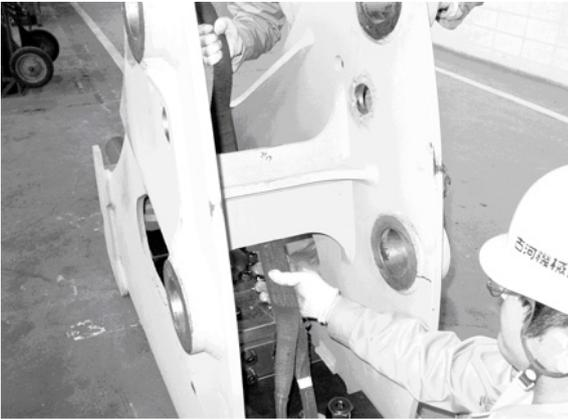
バックヘッド側のスリングの装着位置を変更する
