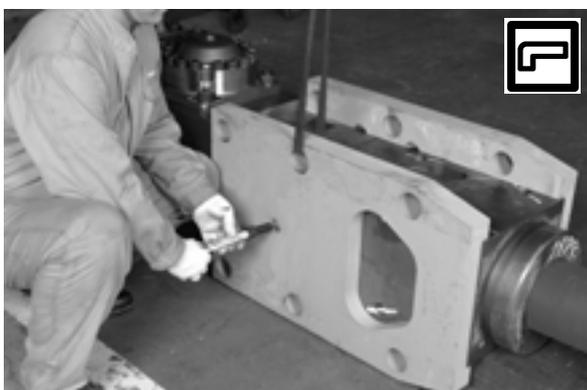
セットプレートを固定していたボルトを外す
