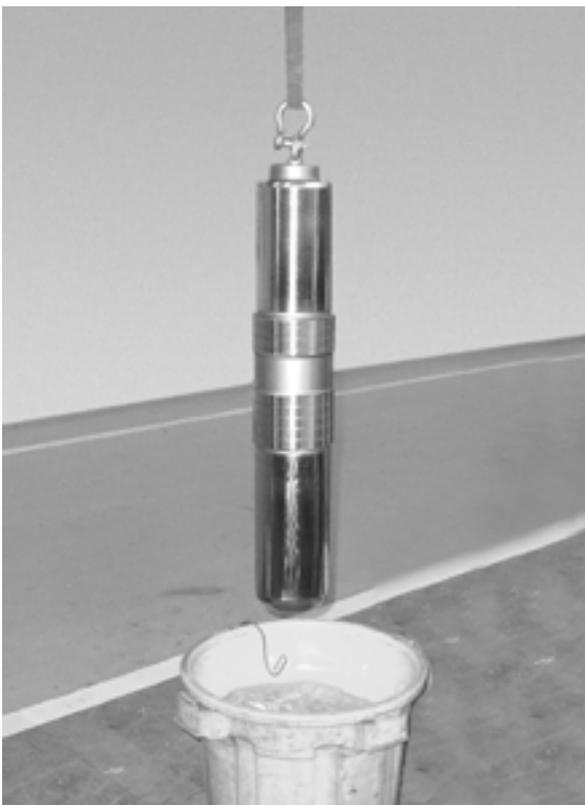
スリングをアイボルトに装着し、ピストンを吊り上げる
