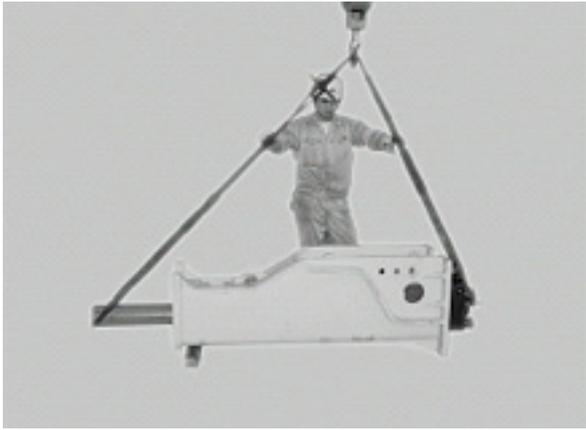
ブレーカを吊り上げて、移動する
