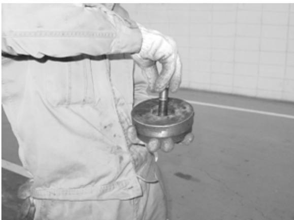
M24 ボルトをプレスアウトヘッドに装着する
