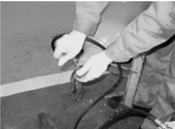
窒素ポンベのバルブを開け、ガスを注入する
