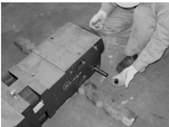
**各フロントヘッドピンを抜く**
