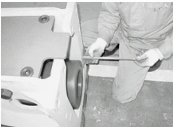
トップダンパが突き出している寸法を測定する
