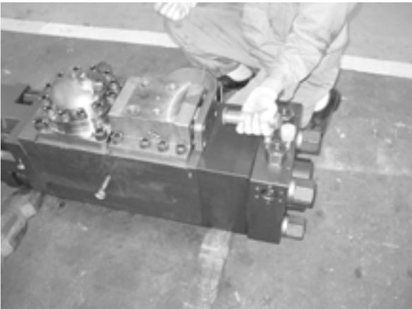
バルブハウジングカバーをバルブハウジングに装着する
