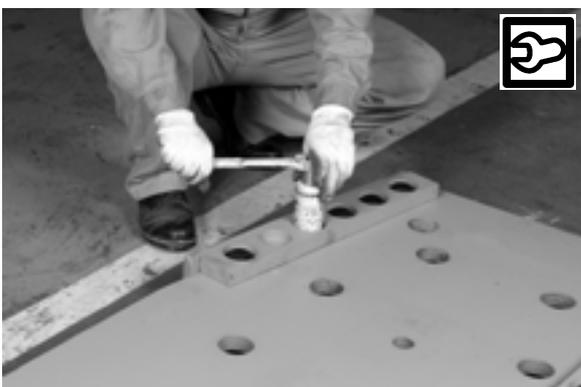
反対側の各ガード(A) (B)も同様の手順で仮組付けする
