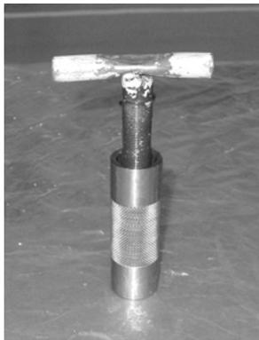
M20 ボルトをスリーブに装着し、完全にスリーブをリサイジングスリーブに挿入する
