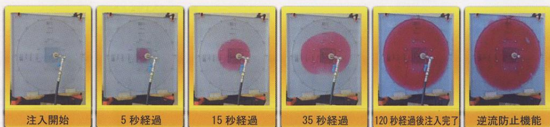
ひび割れ幅を0.25mm（中心部）から0.03mm（円周部）に加工した50cm×50cmのテスト板を使用
